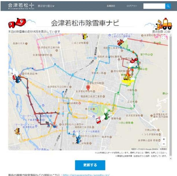
全除雪車に配備したスマートフォンのGPS機能を活用して利用者が地図上の除雪路線のどの位置で除雪車が作業をしているかをリアルタイムで確認することができる。対象エリアは会津若松市が管理している市道約830kmと歩道116kmで、パソコンやスマートフォンから24時間いつでも閲覧が可能。除雪中に路上駐車や倒木などで作業が出来ない際は、スマートフォンで撮影した写真を担当部局に送信し、スムーズな対応が出来るなどの利点もある。
